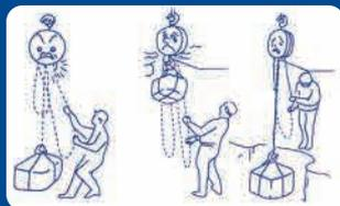
No coloque la carga en la punta del gancho. No amarre la carga directamente con la cadena. Mantenga a cualquier persona fuera del área donde esta la carga.
