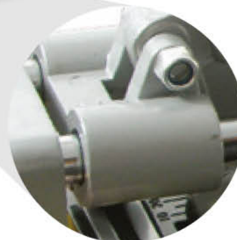
Correderas con baleros para reducir la fricción.
