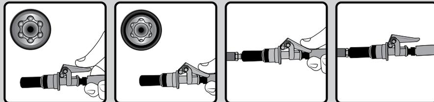
Para conectar, simplemente presione la palanca con el dedo pulgar y deslice la quijada en el equipo o maquinaria a lubricar.
